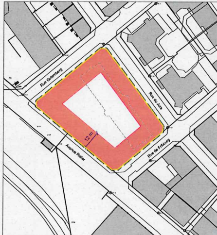
Surface d'emprise au sol (basée sur les limites de construction de l'îlot)
